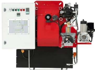
Quemadores duales de gas/fuel-oil pesado de 2 llamas progresivas (hi-low flame) o modulantes (PID fully modulating) junto con el kit opcional de modulación (digital) y la sonda (para el control de temperatura o presión). Ventilador de alta presurización, cabeza de combustión de alto rendimiento con regulación y elevada estabilidad de llama, completos de la llama piloto de encendido de gas.
