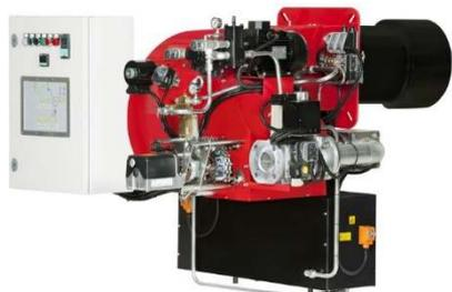
Quemadores duales de gas/fuel-oil pesado de 2 llamas progresivos (hi-low flame) o modulantes (PID fully modulating) junto con el kit opcional de modulación (digital) y la sonda (para el control de temperatura o presión). Ventilador de alta presurización, cabeza de combustión de alto rendimiento con regulación y elevada estabilidad de llama, completos de llama piloto de encendido de gas.
